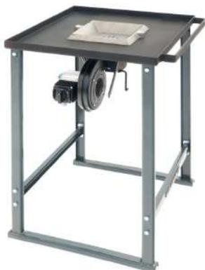
Forge à charbon robuste, performante et pratique. Foyer en fonte EE1 dimensions intérieur 215x195 mm. Réglage d'air précis par un clapet à levier et 2ème clapet pour évacuer le mâchefer. Pieds en profilés démontables. Etriers pour suspendre les outils.
