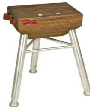
Isostatisme parfait quel que soit le terrain. Très grande rigidité. Bloc bois en lamellé collé de très forte épaisseur. Livré avec 4 équerres de coins pour caler l'enclume. Pour enclume d'un poids maximum de 80 kg.
