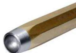
Outil qui permet de former le rivet. A utiliser avec les rivets à tête ronde en acier. On place la tête du rivet contre l'enclume par exemple puis on positionne la bouterolle sur la partie à rabattre de la tige du rivet avant de frapper pour former le rivet.
