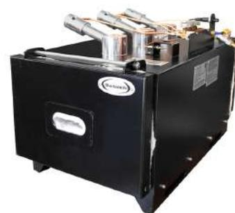
Chaque brûleur est muni d'une vanne qui permet de diminuer sa puissance voire de le couper. Construction robuste. Isolation en fibre céramique d'épaisseur 5 cm. Sole en brique réfractaire.
