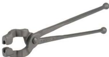
Pincettes de forge en U décalé permettant de serrer la matière par le côté (permet de laisser dépasser la matière le long de la tenaille). Pour serrer des fers plats sur le chant section 10x6, 25x6, 38x6 ou 50x6 mm.
