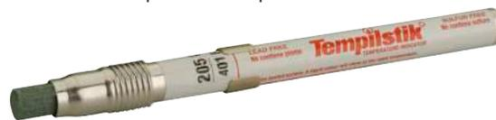
C'est un moyen simple et efficace pour contrôler la température directement sur la pièce chauffée. Le dépôt solide laissé par cette craie grasse sur la pièce mise au four se liquéfie à la température indiquée. Idéal pour vérifier les températures en soudure, traitements thermiques ou fonderie.
