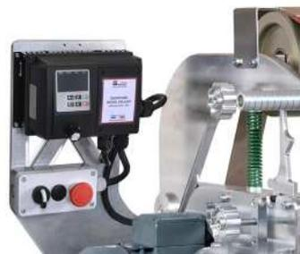
*Variateur modèle Vario Eco sur moteur 1500 Watt - mono*
