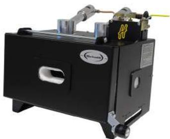
Forge à gaz portable à 2 brûleurs. Modèle robuste avec 2 ouvertures latérales prévues pour permettre le passage de barres. Il suffit de découper la fibre isolante pour les ouvrir.
