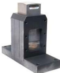
Utilisée pour forger/planer des lopins Damas ou des Damas box. Outils 60x60 mm acier pour travail à chaud W300. Dureté 55 HRc. Section 60x60 mm Livrée avec un jeu de matrices plates section 60 x 60 mm.
