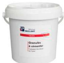
La cémentation est un traitement thermo-chimique consiste à faire pénétrer superficiellement du carbone dans un acier doux, afin de le transformer en surface en un acier fortement carburé susceptible de recevoir une trempe de durcissement.
