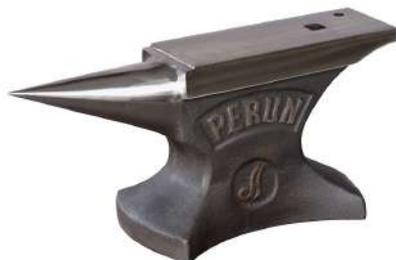
Magnifique enclume idéale pour la coutellerie et la maréchalerie. Acier moulé, trempé (table et arêtes) puis plané. Finition parfaite. La table offre un épaulement à la jonction avec la bigorne. La bigorne est extrêmement lisse et parfaitement régulière pour des travaux très précis.
