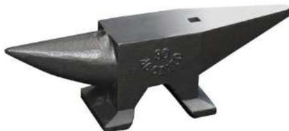
Enclume type serrurier en acier moulé, trempé et plané. Modèle économique en acier. Table large. Double bigorne. 1 trou carré 22 mm + trou rond. Grande robustesse.
